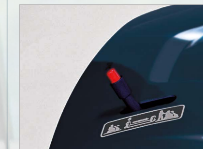
Alavanca de desengate de dois passos para evitar que a Scooter ande sozinha
